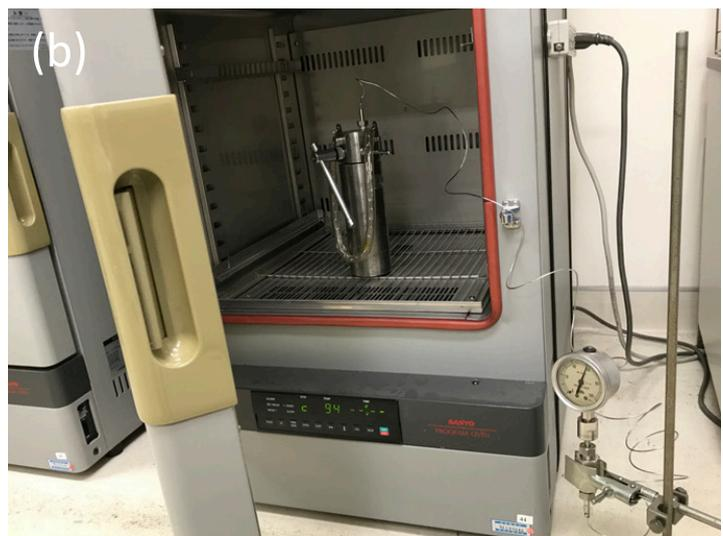
絶対好圧性・超好熱性・嫌気性アーキア (*Pyrococcus yayanosii* JCM 16557<sup>T</sup>) の培養例。(a)はシリンダー中に置いた培養瓶。シリンジは瓶内の高圧を維持するために穿刺しているが、シリンダー内の容積は小さいため針を曲げて入れている。(b)は培養に使用する高圧容器を培養器に置いた様子。圧力ゲージは耐熱性が弱いため培養器の外側に設置。
