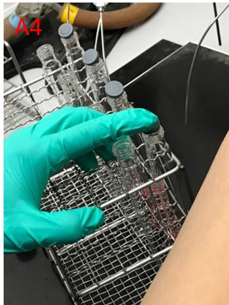
無酸素ガスを通気してある培養器にシリンジを用いて分注します（A3）。その後にブチルゴム栓で密栓してオートクレーブします（A4）。
