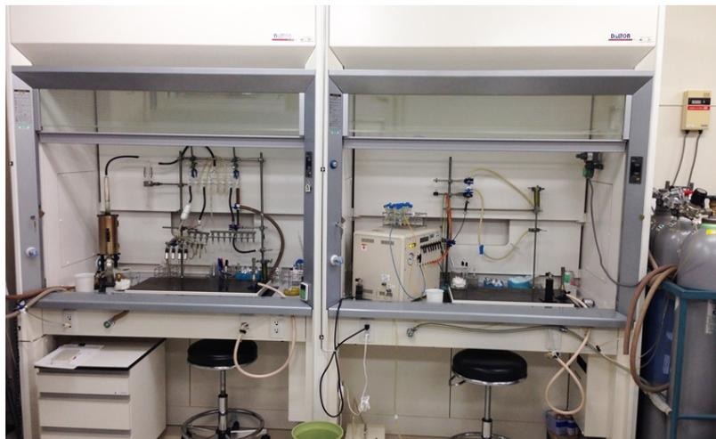
ドラフト左側はガス噴射法のためのワークスペース、右側はガス置換装置を使用したワークスペース。
